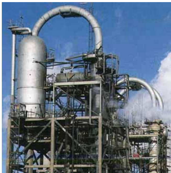
Σχημα 4.2. Αντιδραστήρας καταλυτικής σύνθεσης υδρογονανθράκων του γενικού τύπου (CH 2 ) x , με τη μέθοδο Fisher-Tropsch:
